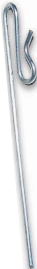
La crosse se glisse dans l'encoche usée et coupée, le long bras se cale dans le pli formé par le tréfilage des encoches. Facile à mettre en place, sa forme et sa courbure assure sa tenue. La pièce est en acier ressort galvanisé de 2.00 mm, elle se pose sans outil et va rester en place en permanence sur le profilé.
